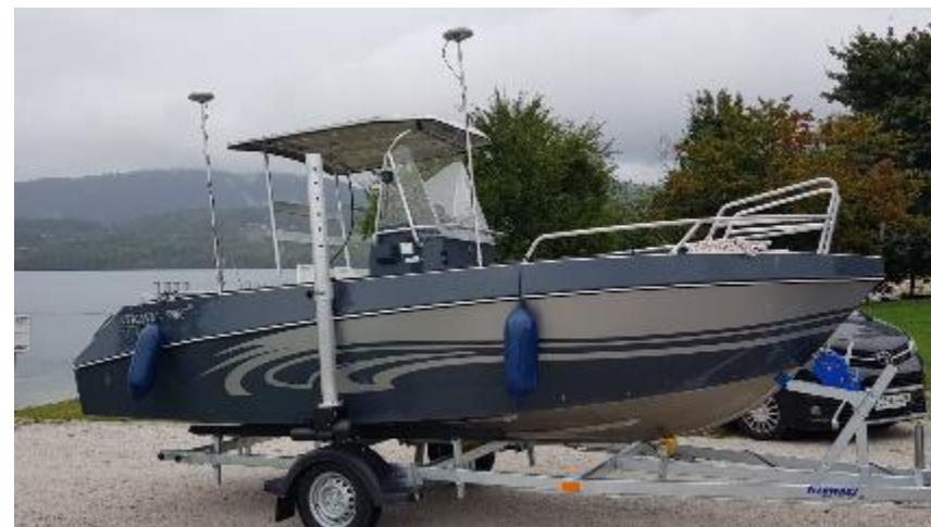
Viking – 550 C: Nameski čoln za soniranje dna pri hidroelektrarnah (Slovenija).
