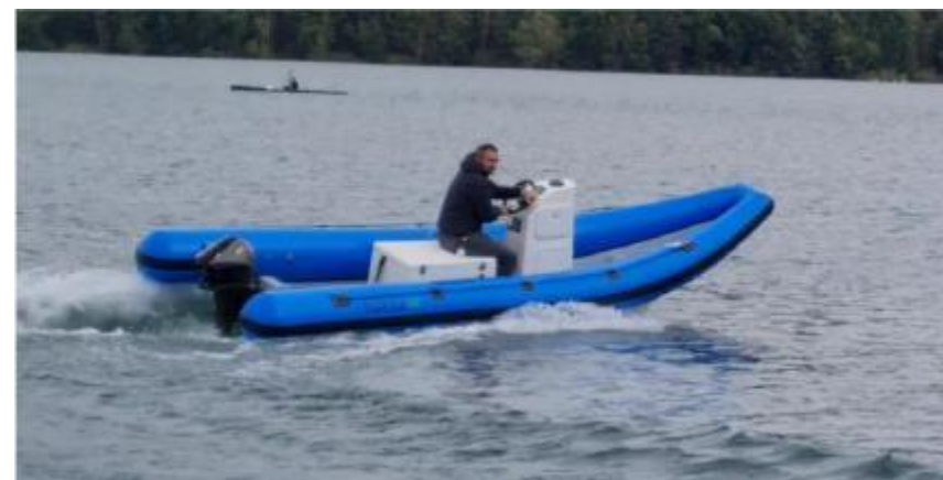
VSR Lab – VSR 6.0: Električni čoln z vgrajenim agregatom.
