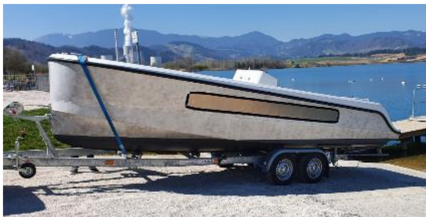
Speedwave – SP7.0: Električno plovilo z vgrajenimi sončnimi celicami (Švica).
